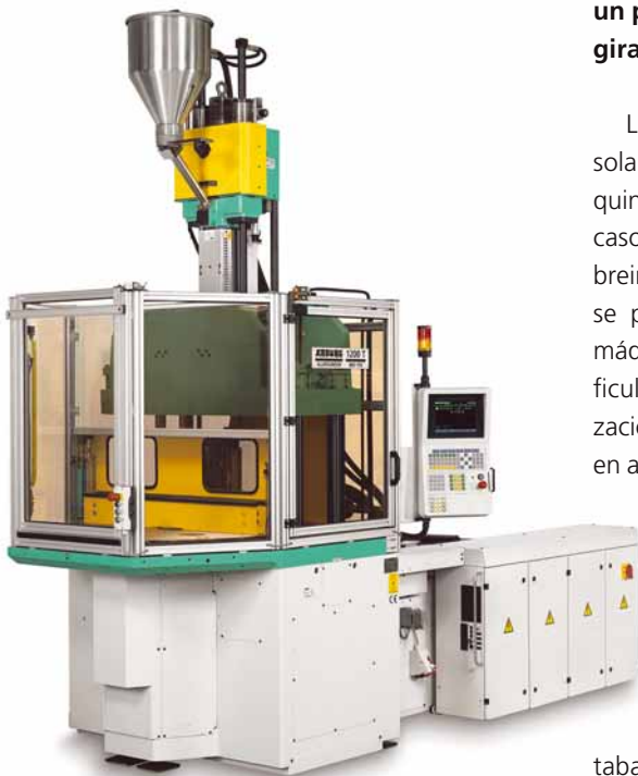
La mesa corrediza Biamat (arriba) es uno de los precursores de las máquinas de mesa giratoria ALLROUNDER T (abajo).
